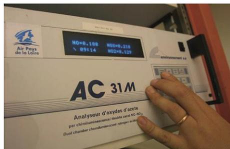
Analyseur automatique d'oxydes d'azote
