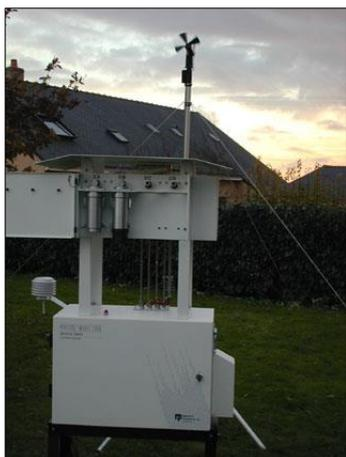
Vue d'un système de prélèvement par filtre
