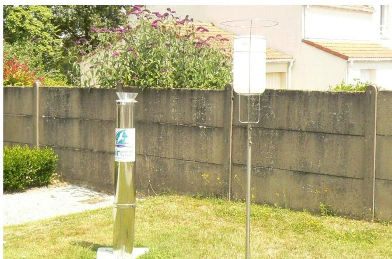
Photo 3 : jauges de récupération des eaux de pluies (à gauche pour l'analyse des dioxines et les furanes, à droite pour les métaux)
