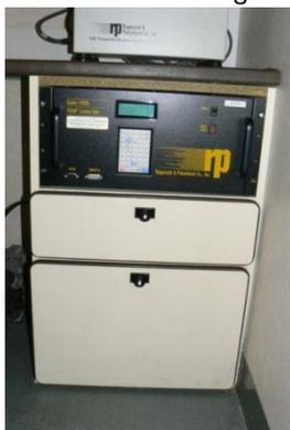
Photo 2 : analyseur de particules fines PM<sub>10</sub> installé dans le camion laboratoire
