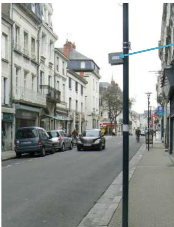
Dispositif de prélèvement du benzène
