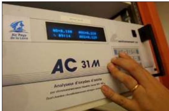
Photo 5 : analyseur automatique d'oxydes d'azote
