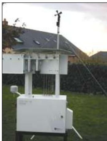
Photo 4 : vue d'un système de prélèvement par filtre
