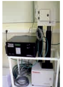
Analyseur TEOM (tapered element oscillating microbalance) équipé d'un module FDMS (filter dynamics measurement system)
