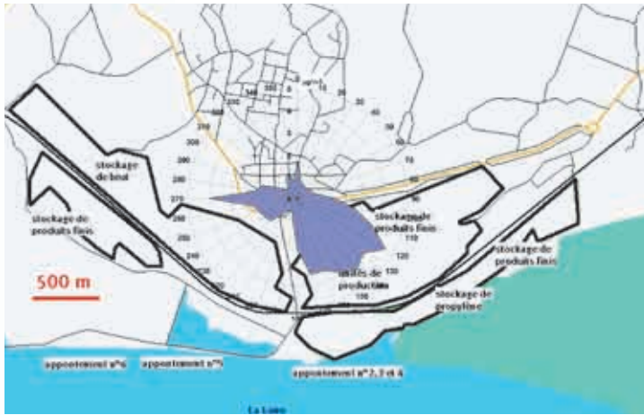
Rose de pollution des niveaux moyens de benzène mesurés rue Pasteur à Donges entre le 19 septembre 2006 et le 17 janvier 2007
