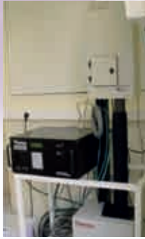
Analyseur de poussières fines PM10 équipé de son nouveau module FDMS (filter dynamics measurement system)
