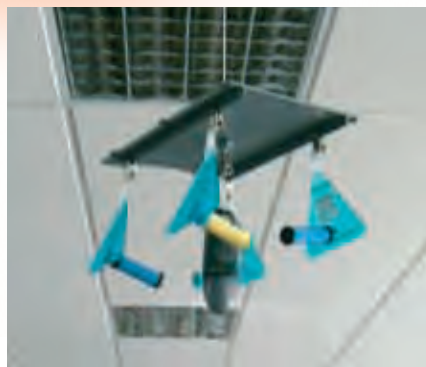
Dispositif de mesure des Cov dans un établissement scolaire nantais
