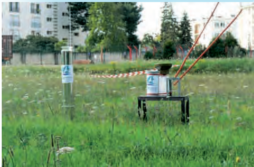
Projet SAP: collecteurs d'eau de pluie à Nantes
