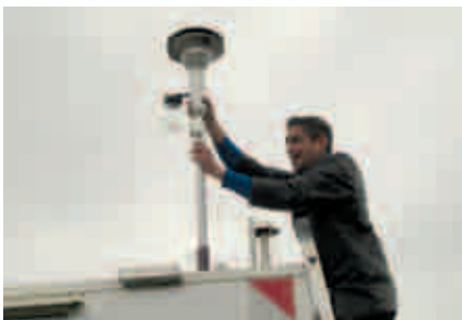
Dispositif de mesure (tête PM10 équipée d'un impacteur PM2,5)
