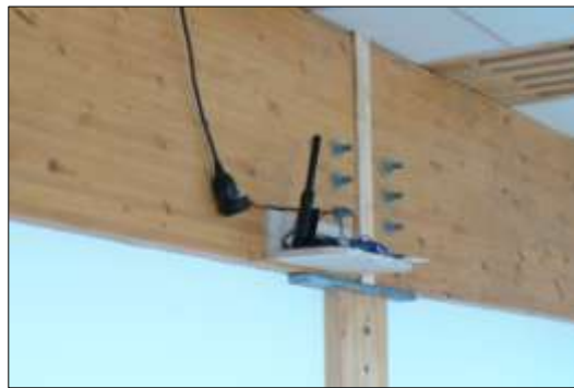
Photo 3 et Photo 4 : appareil Q-Track mesurant le dioxyde de carbone, la température et l'humidité
