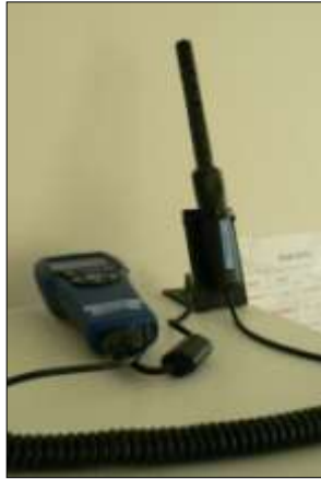
Photo 3 et Photo 4 : appareil Q-Track mesurant le dioxyde de carbone, la température et l'humidité
