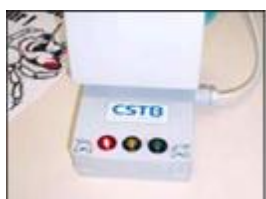
Photo 2 : appareil LUM'AIR mesurant le confinement
