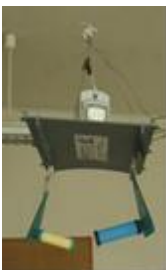
Photo 1 : tubes à diffusion passive mesurant les COV et sonde température installés dans une salle de classe
