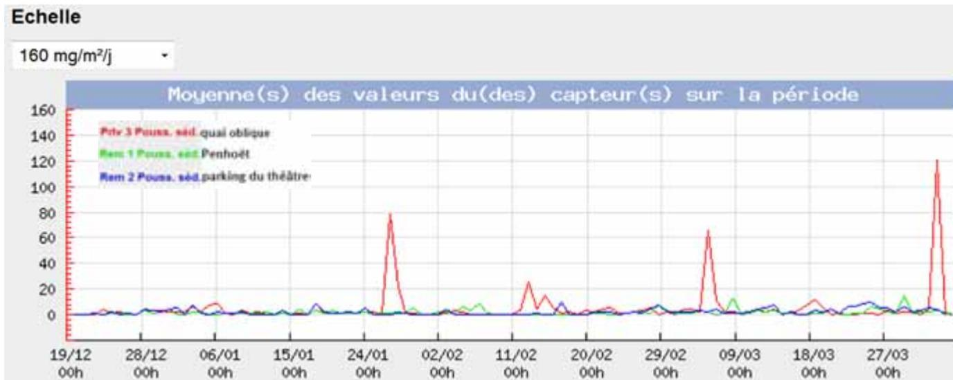
Figure 17: profils de particules sédimentables en  $\text{mg}/\text{m}^2/\text{j}$  du 19/12/11 au 05/04/12
