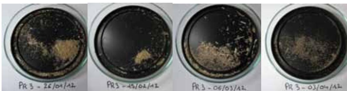
Figure 18 : photos des 4 dépôts majeurs collectés sur le site du quai oblique au cours de la campagne de mesure
