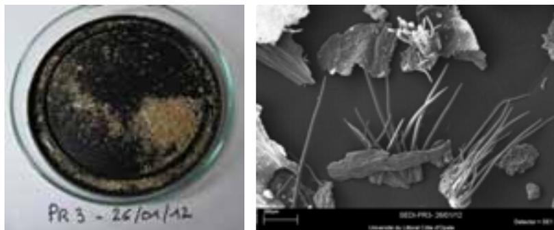
Dépôt de blé collecté le 26 janvier 2012 sur le site du quai oblique (à gauche) – particules de blé du dépôt visualisé au MEB (à droite)
