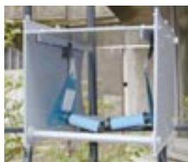
Tubes à diffusion passive pour la mesure du benzène
