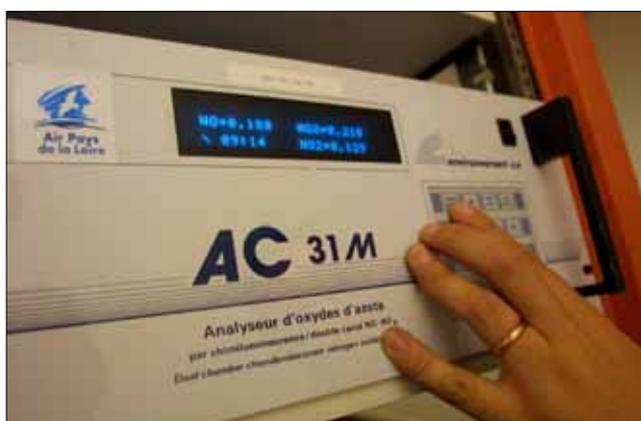
Photo 3 : analyseur d'oxydes d'azote
