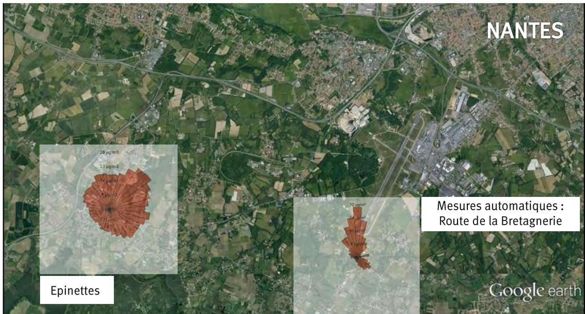
Rose des concentrations moyennes en dioxyde d'azote pour la station de mesure Epinettes et les mesures automatiques réalisées Route de la Bretagne du 5 février au 5 mars 2014
