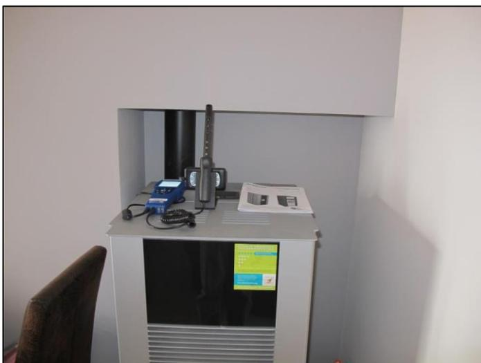
Photos 6 : appareil de mesure du dioxyde de carbone, de l'humidité relative et de la température lors de la seconde phase de l'étude (9 au 13 septembre 2013).
