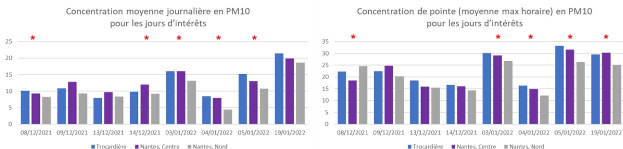
Figure 13 : concentrations moyennes journalières (à gauche) et de pointe (maxima horaire, à droite) en PM10 pour les 8 jours d'intérêts
