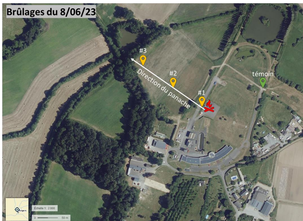
Figure 1 : dispositif de mesure déployé lors des essais incendie du 8 juin 2023 (mesures par canisters uniquement)
