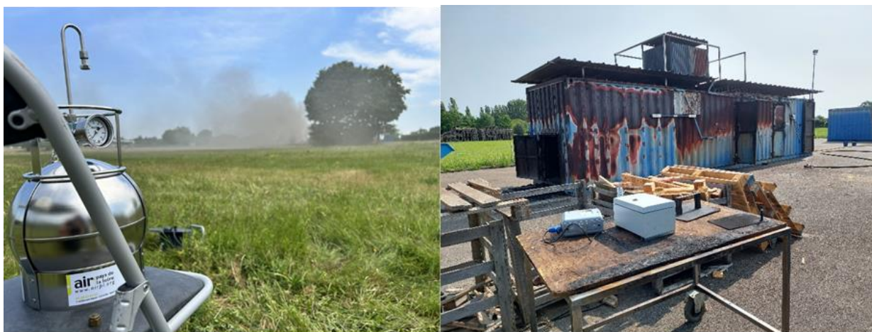
Figure 3 : pose du canister sous le panache sur le site à 100 mètres (à gauche). Pose de la ministation EcoMesure sur le site dans l'environnement immédiat de l'incendie (à droite)
