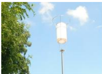
Figure 3 : jauges de récupération des eaux de pluie, dite « jauge Owen »
