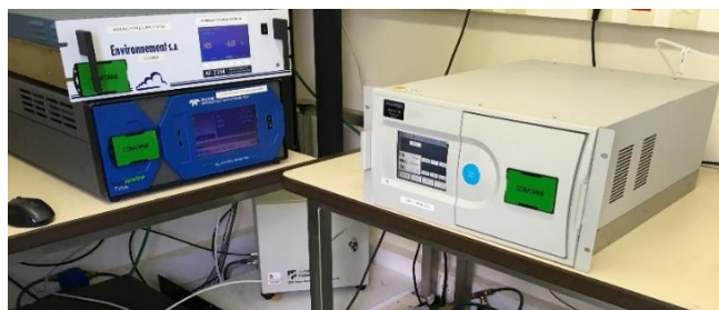
Figure 25 : laboratoire mobile (photo de gauche) et analyseurs de sulfure d'hydrogène (en haut à gauche) et de méthane (à droite) (photo de droite)
