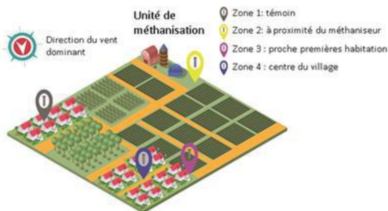
Figure 27 : localisation des tubes de prélèvement d'ammoniac
