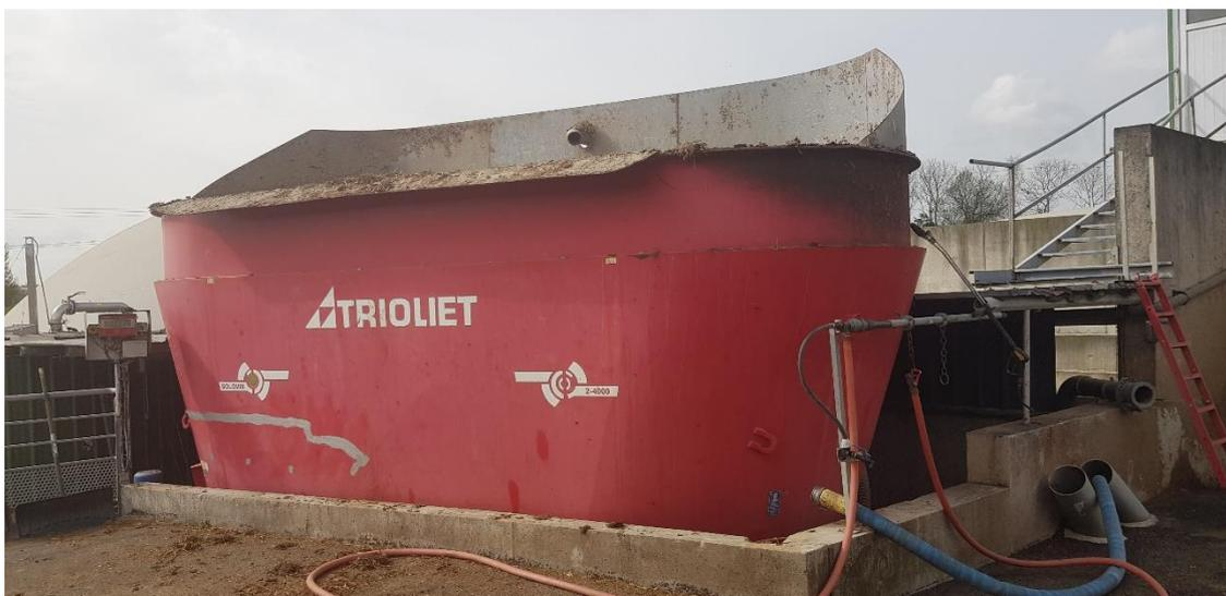
Figure 3 : trémie d'incorporation
