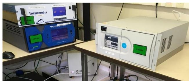
Figure 22 : laboratoire mobile (photo de gauche) et analyseurs de sulfure d'hydrogène (en haut à gauche) et de méthane (à droite) (photo de droite)
