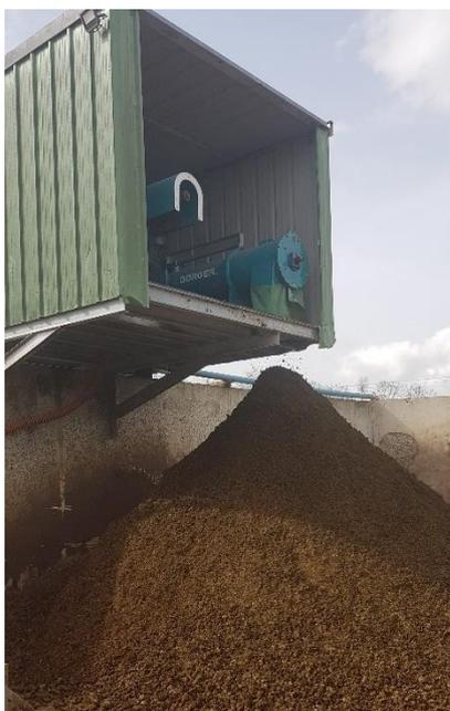
Figure 5 : séparation de phase de la fraction solide
