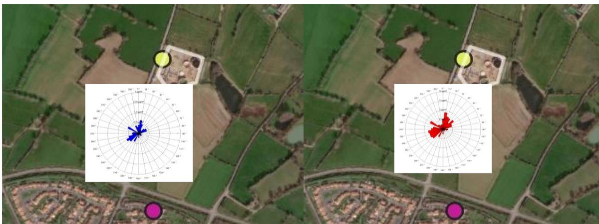
Figure 31 : rose de pollution des concentrations moyennes (à gauche) et de pointe -percentile 98- (à droite) en H<sub>2</sub>S
