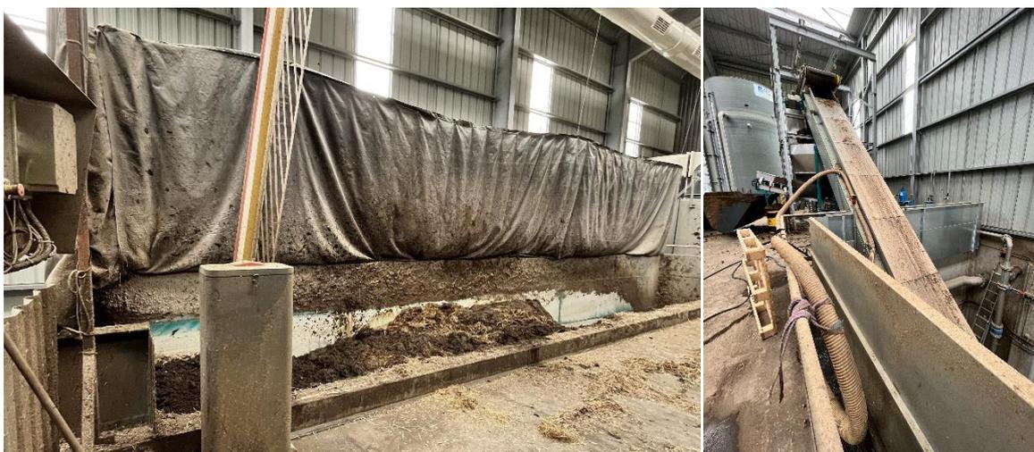
Figure 3 : trémie d'alimentation du méthaniseur
