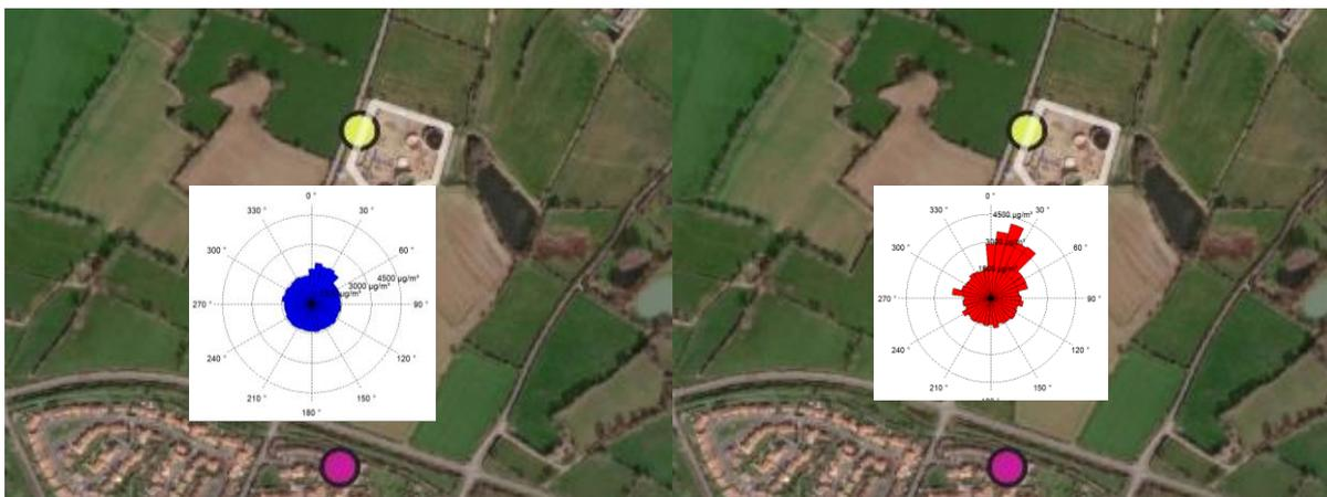
Figure 29 : rose de pollution des concentrations moyennes (à gauche) et de pointe -percentile 98- (à droite) en méthane
