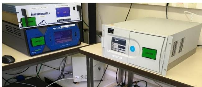
Figure 23 : laboratoire mobile (photo de gauche) et analyseurs de sulfure d'hydrogène (en haut à gauche) et de méthane (à droite) (photo de droite)
