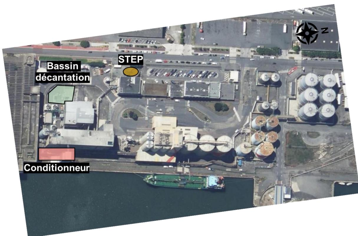
Figure 2 : plan de situation des principales unités de stockage et de production du site Cargill (Saint-Nazaire). (échelle : 1/1400)
