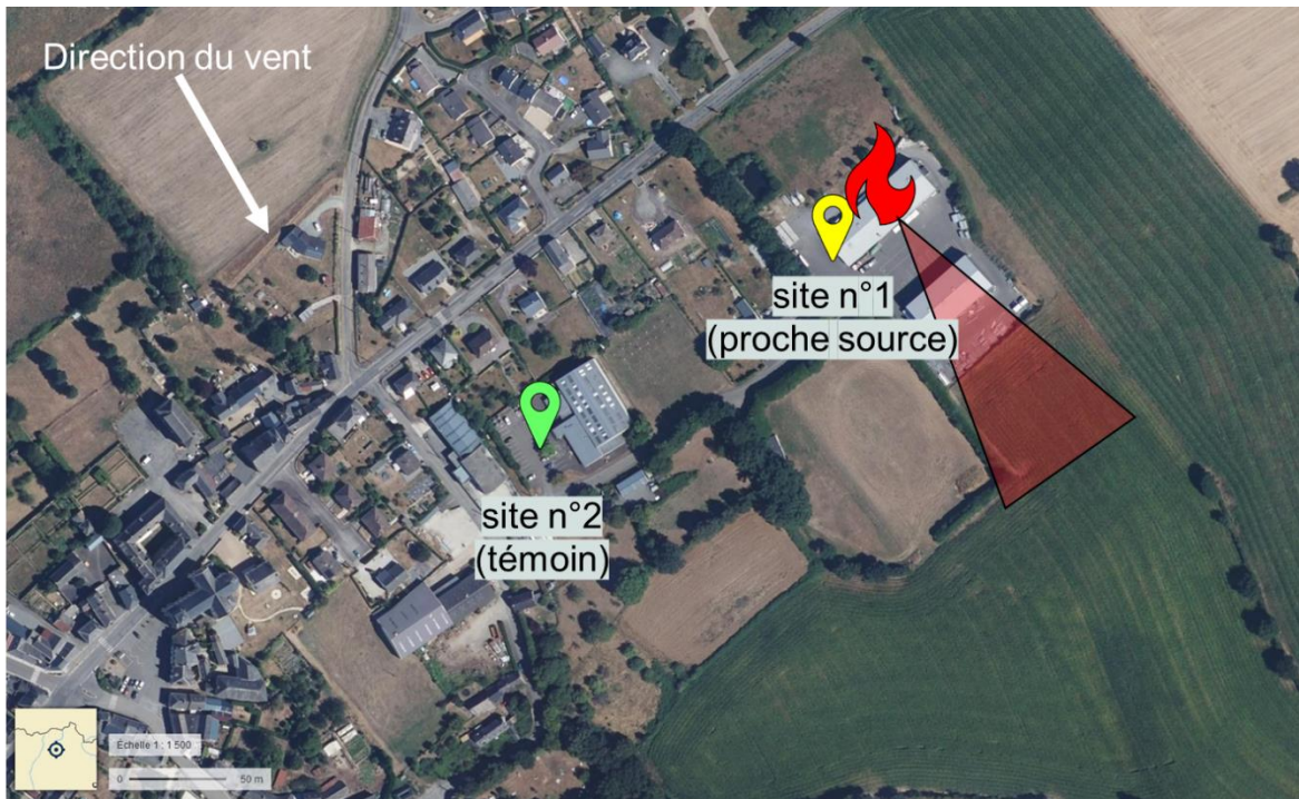
Figure 1 : situation géographique de l'industrie sinistrée, du site de mesure sous influence (site n°1) et du site témoin (site n°2), ainsi que la direction du vent au moment de l'évènement. La source de l'incendie est matérialisée par la flamme, et la direction du panache par la zone rouge (source : carte IGN)
