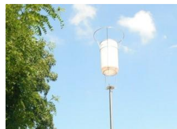
Figure 3 : préleveur d'eau de pluie (jauge Owen)
