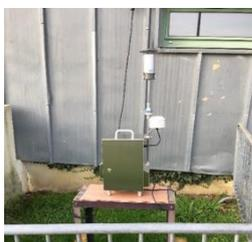
Figure 2 : préleveur d'acide cyanhydrique gazeux
