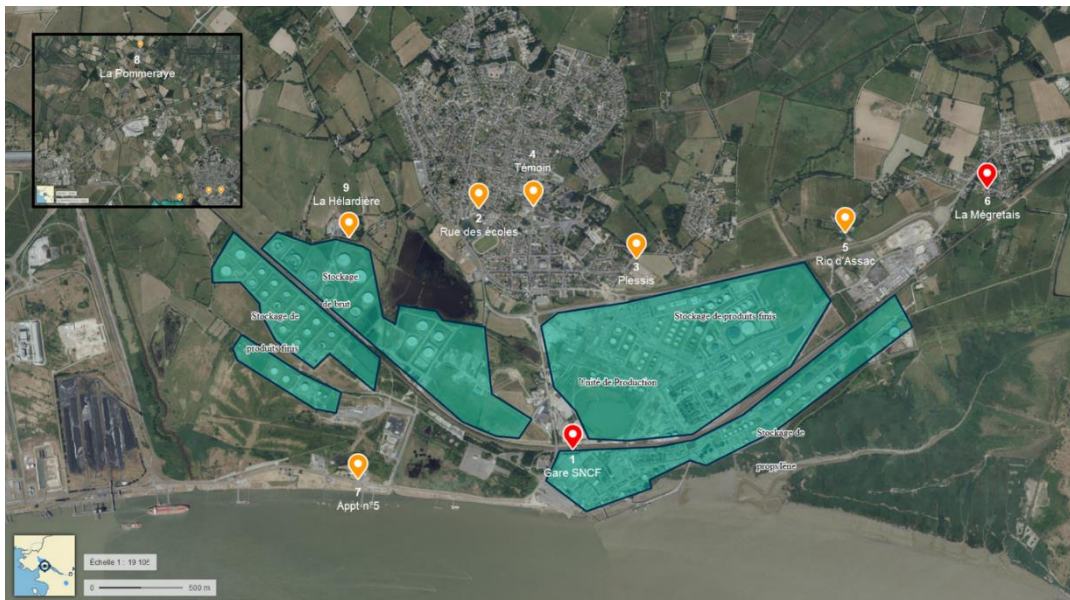
Figure 2 : localisation des points de mesure dans l'environnement de la raffinerie. En rouge : les 2 sites de mesure choisis comme lieux d'implantation des mesures automatiques en plus des mesures passives
