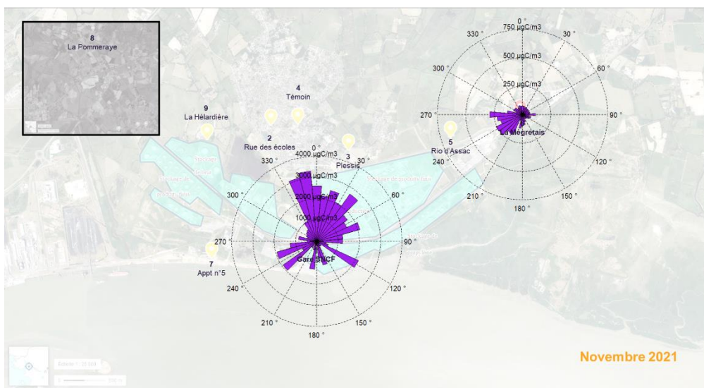
Figure 18 : roses de concentration des niveaux de pointe (P-98) en COVnM mesurés sur les sites de la Gare SNCF et de La Mégretais au cours de la campagne de novembre 2021
