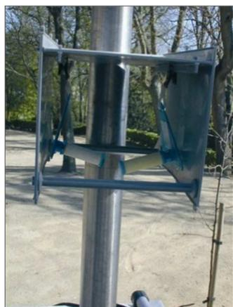
Figure 9 : tubes à diffusion passive installés dans leur boîte de protection
