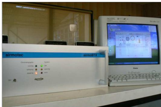
Figure 14 : analyseur automatique de benzène
