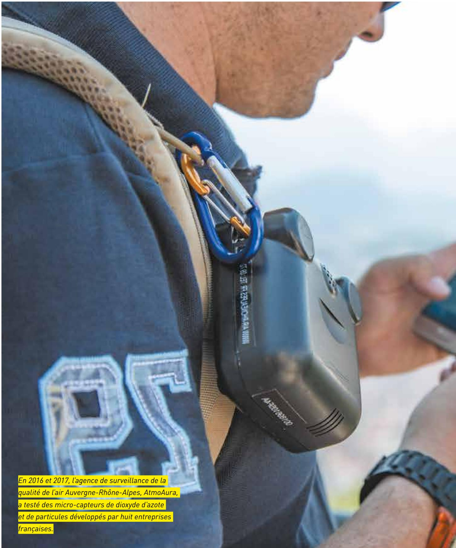
En 2016 et 2017, l'agence de surveillance de la qualité de l'air Auvergne-Rhône-Alpes, AtmoAura, a testé des micro-captureurs de dioxyde d'azote et de particules développés par huit entreprises françaises.
