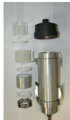
Cartouche chemcomb incluant dénudeurs et portes filtres permettant la mesure du nitrate et de l'ammonium particulaires
