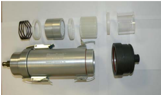
Photo 3 : vue éclatée d'une cartouche Chemcomb utilisée pour la collecte du nitrate de l'ammonium particulaire
