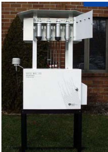
Photo 4 : Partisol Spéciation utilisé pour la collecte du nitrate et de l'ammonium particulaire
