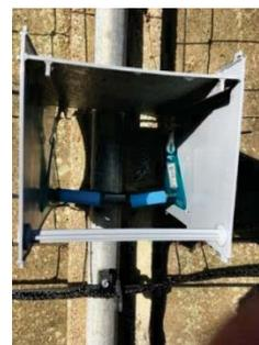
Figure 6 : tubes à diffusion passive et boîte de protection
