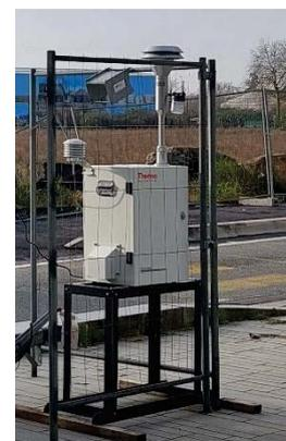
Figure 7 : préleveur pour la mesure des métaux
