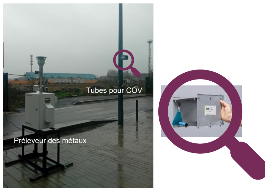
Photo 4 : préleveur et tubes à diffusion passive
