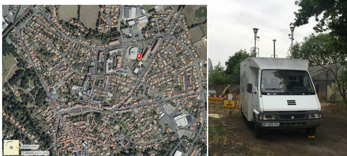
Figure 3 : localisation du laboratoire mobile de mesure à proximité du centre-ville de Montaigu, et illustration du laboratoire mobile
