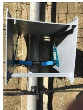
Figure 4 : tubes à diffusion passive et boîte de protection
