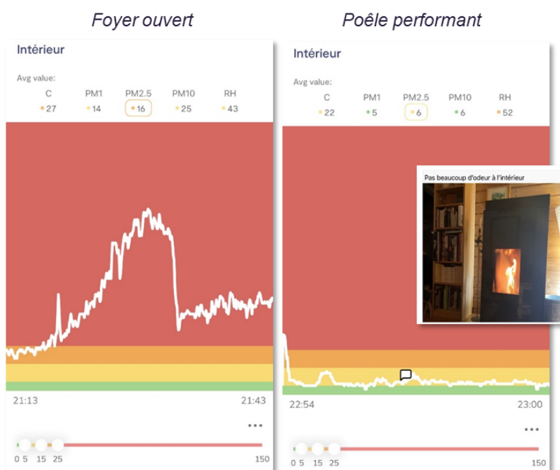
Figure 6 : exemples de mesures effectuées (à gauche : lors de l'allumage d'un feu de bois dans une installation ancienne. À droite : lors de l'allumage d'un poêle à bois performant)
