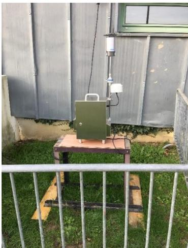
Vue d'un système de prélèvement par filtre
