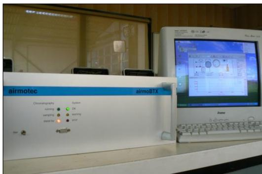
Photo 3 : analyseur automatique de benzène
