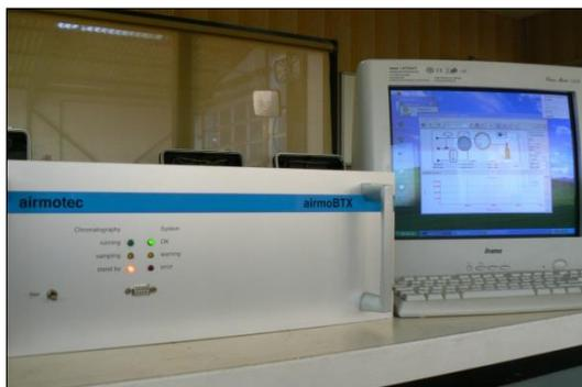
Photo 3 : analyseur automatique de benzène
