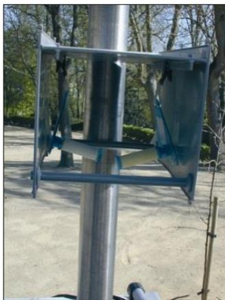
Photo 2 : tubes à diffusion passive installés dans leur boîte de protection
